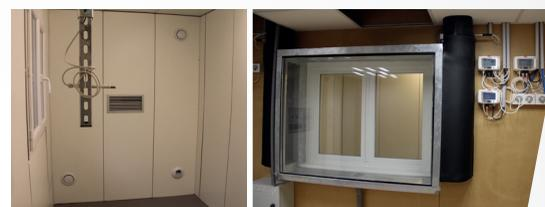
Le bâtiment héberge notamment un caisson de 16m<sup>3</sup> permettant, de manière contrôlée, de reproduire un large spectre d'ambiances hygrothermiques et d'écoulements d'air ainsi qu'un appartement de 100m<sup>2</sup>, alimenté par 9 sources d'énergie - d'origine renouvelable ou non, reconfigurable, instrumenté et connecté.
